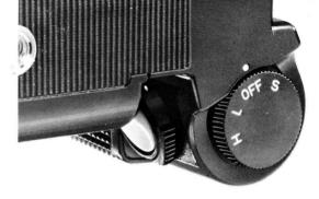
わせて押付けながら、モータードライブの ロックボタンを押します。着脱ノブが作動 してバッテリーパックが固定されます。
